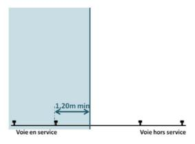
Le **contour limite du gabarit des obstacles** peut être assimilé à un plan situé à une distance minimale de **1,20 m mesurée latéralement à partir du bord intérieur du rail** le plus proche de la voie voisine en service.
