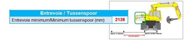
Si l'entrevoie au droit de la zone de chantier est supérieure ou égale à l'entrevoie minimum mentionnée dans l'agrément Infrabel, alors aucun empiètement de type II n'est occasionné par l'engin (par exemple par l'arrière de la cabine de la grue rail-route).
