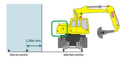
Si l'entrevoie au droit de la zone de chantier est inférieure à l'entrevoie minimum mentionnée dans l'agrément Infrabel, alors un empiètement de type II occasionné par l'engin (par exemple par l'arrière de la cabine de la grue rail-route) est à prendre en compte.
