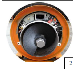
Figure 2.16: Arrière du microtunnelier (2)
