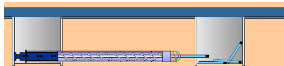
Figure 2.19 : Fonçage avec tige pilote –curage à la tarière
