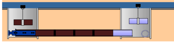
Afbeelding 2.21 - Pilotstangdoorpersing napersen productbuis
