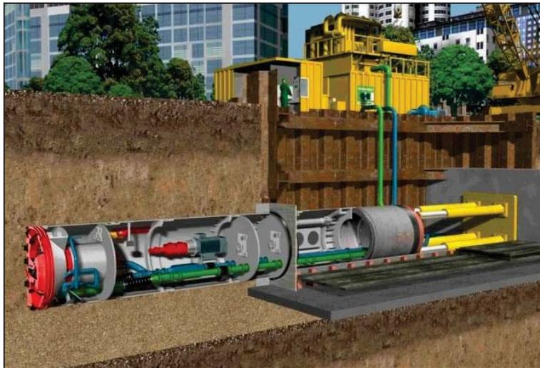
Figure 2.13 : Technique du front fermé
